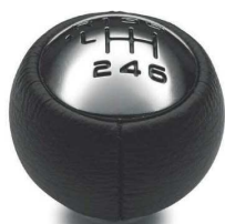
Шкіряна насадка на важіль перемикачів передач з хромованою вставкою
